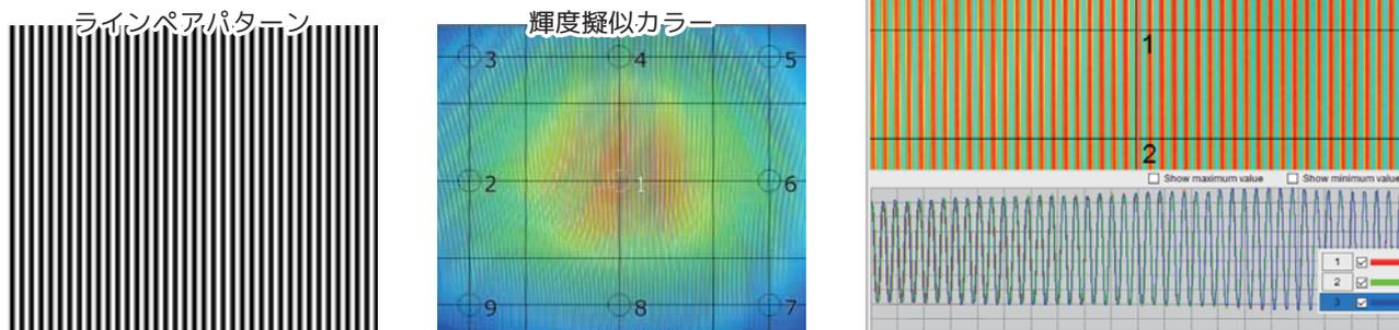
Fig.7 ラインペアパターンと測定結果イメージ例
