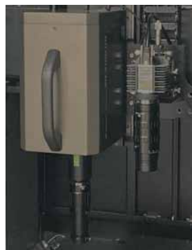
2D 分光放射計 SR-5100HM を併用した補正システム
