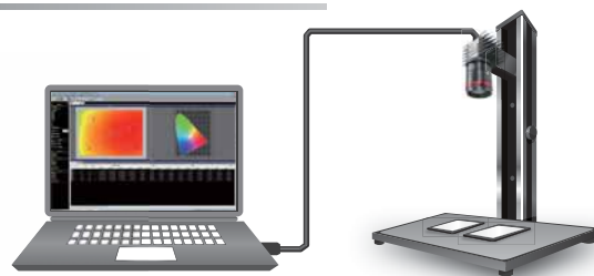
2D 分光放射計 SR-5100HM を併用した補正システム
