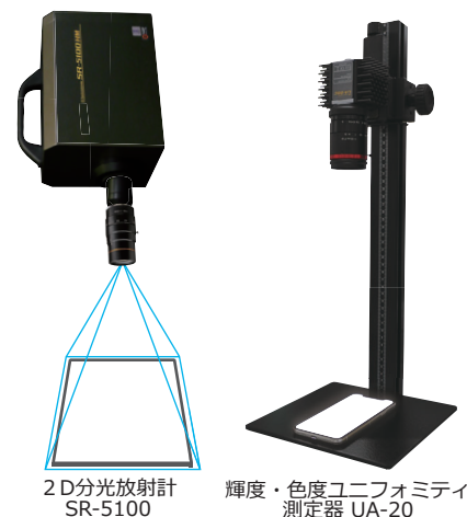
Fig.1輝度・色度・均一性測定イメージ
