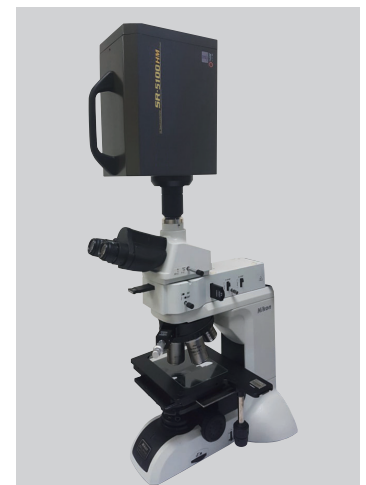
Fig.7 SR-5100HM+ 金属顕微鏡
